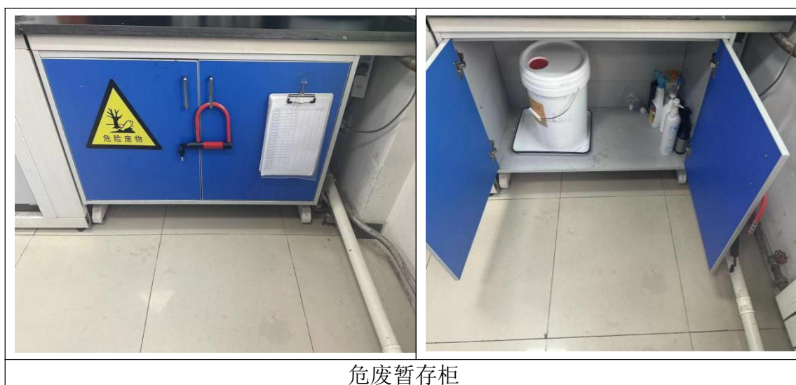
图 5.1-4 危废暂存柜照片
